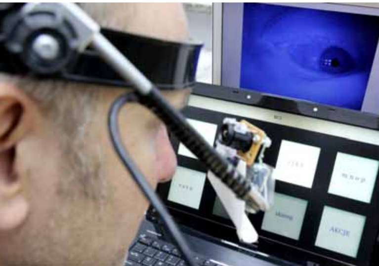
Rys. 6. Pierwszy prototyp okulo grafu wykonanego na UW z użyciem kamarki od konsoli PS3 i oprogramowania OpenBCI.
